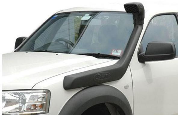
U vozidel dodatečně upravených na pohon LPG/CNG se někdy vyřazuje z činnosti náporové sání (je provedeno přepojení vstupu sání z prostoru za přední maskou či pod nárazníkem do motorového prostoru) i předehřívání teplého vzduchu od výfuku. V těchto případech takový stav nehodnotíme jako závadu.
