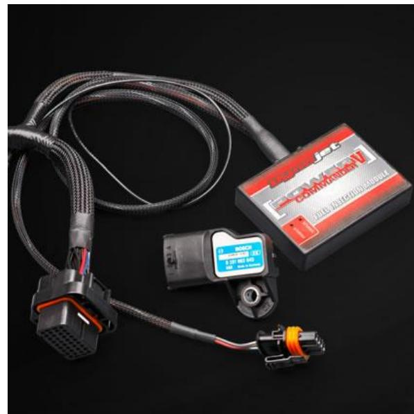
Korekční jednotky typu PowerCommander. Vlevo jednotka, která se připojuje na výstup ovládání vstřikovačů, vpravo jednotka ovlivňující snímač plnícího tlaku turbodmychadla s kabelovým mezikusem pro připojení k původní elektroinstalaci vozidla.
