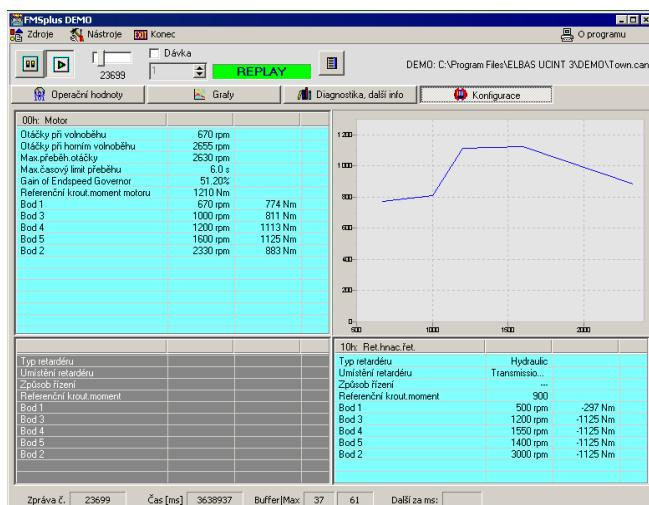
*Identifikace výkonové verze motoru užitkového vozidla pomocí analýzy sběrnice Can dle SAE J1939*
